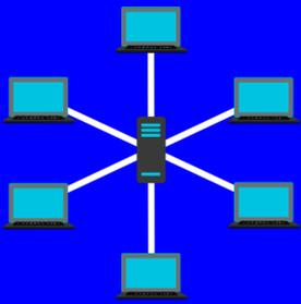
**TOPOLOGÍA DE ESTRELLA:** Es aquella en donde los dispositivos están conectados a un switch que es el componente central, un fallo en algún equipo es fácil de detectar y solucionar, gracias al switch o hub.
