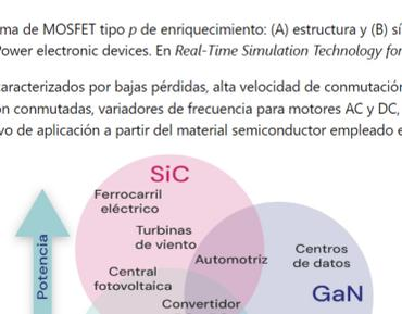
Figura 5. Áreas de aplicación de MOSFET de potencia.
