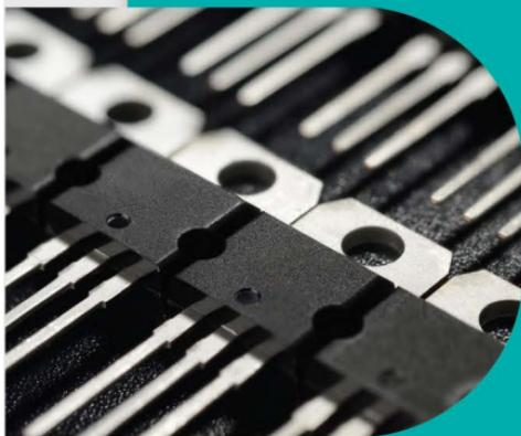
El transistor de efecto de campo metal-óxido-semiconductor **MOSFET** es un dispositivo electrónico de estado sólido de tres terminales. Comercialmente, pueden encontrarse encapsulados en diferentes tamaños y formas, así que es importante consultar las hojas de datos de los fabricantes para identificar, de manera correcta, el orden de las terminales y el tipo de canal.
