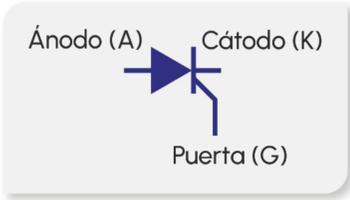
Figura 3. Símbolo eléctrico de un SCR.
