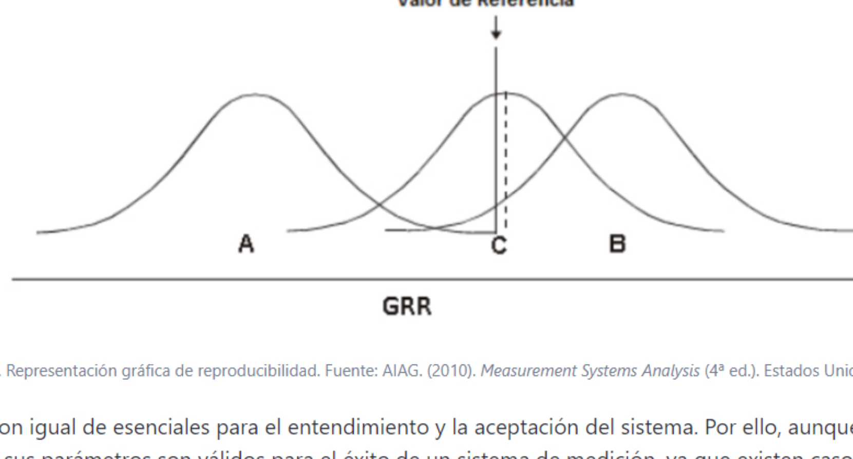
Figura 1. Representación gráfica de reproducibilidad. Fuente: AIAG. (2010). Measurement Systems Analysis (4ª ed.). Estados Unidos.
