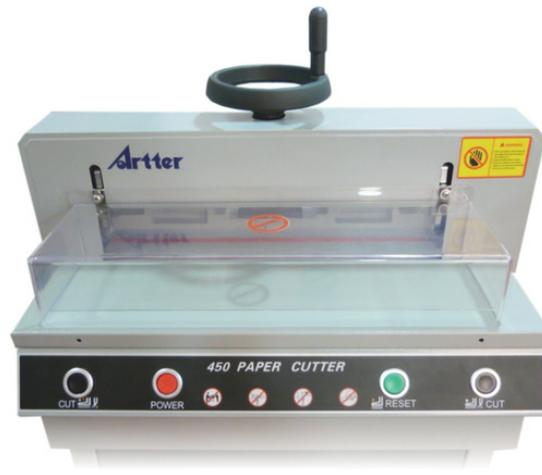
Por seguridad, la computadora digital interna de la máquina no debe permitir el accionamiento de la cuchilla cuando los dedos del operador se encuentren en la trayectoria de la cuchilla, por lo tanto, el diseñador agrega un par de botones en cada extremo con la leyenda “cut” en ellos, así la cuchilla se accionará si el botón 1 & el botón 2 están activados, obligando al usuario a emplear ambas manos para activar los botones y así, asegurar que no se encuentran en la trayectoria de la cuchilla.
